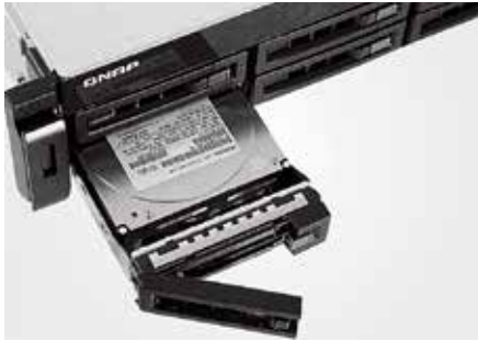
▲ Как и любой NAS, TS-EC879U-RP неприхотлив в использовании – замена HDD производится очень легко
